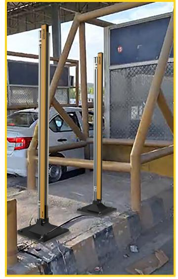
In questa applicazione le barriere di sicurezzza EOS sono poste all'ingresso della corsia di pedaggio per rilevarei la presenza del veicolo e abilitare la lettura dello stato del trasposnder sul veicolo.
