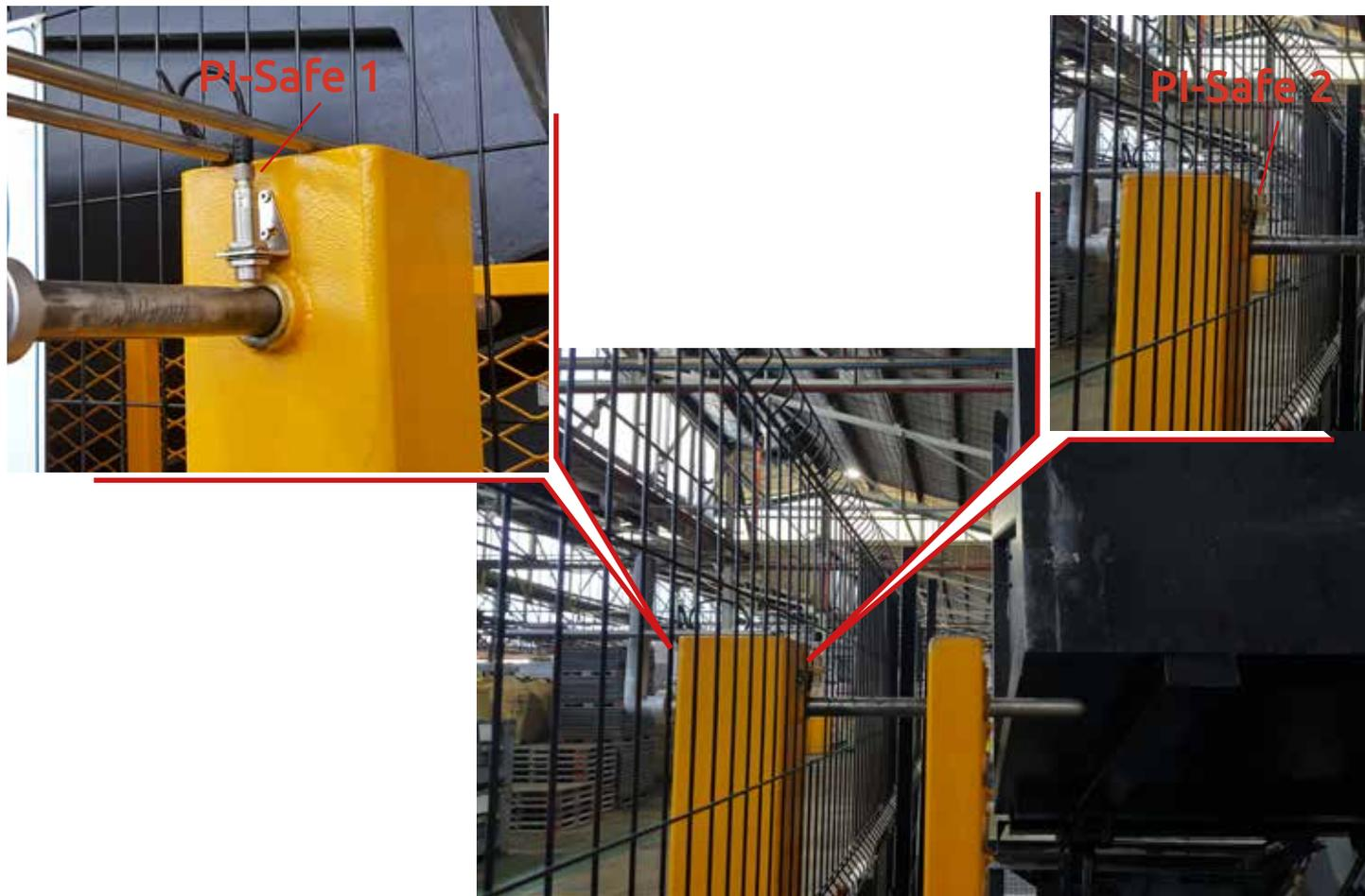
Il terzo sul pavimento per garantire che il cassone sia completamente a terra prima che l'operatore possa entrare nell'area pericolosa.
