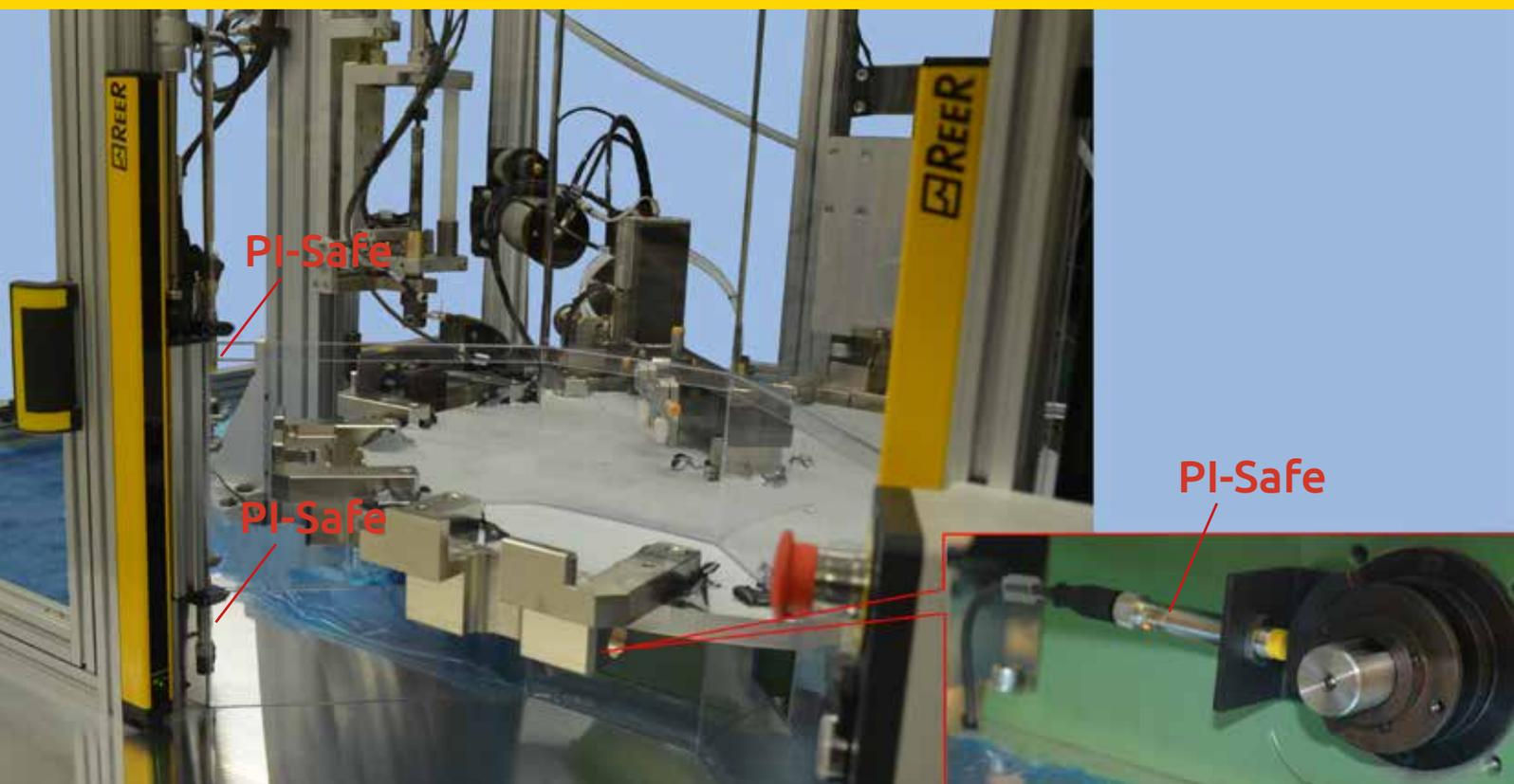
Le verifiche di posizione della paratia e dalla tavola rotante sono realizzate tramite dei sensori induttivi di sicurezza PI-Safe M12.
