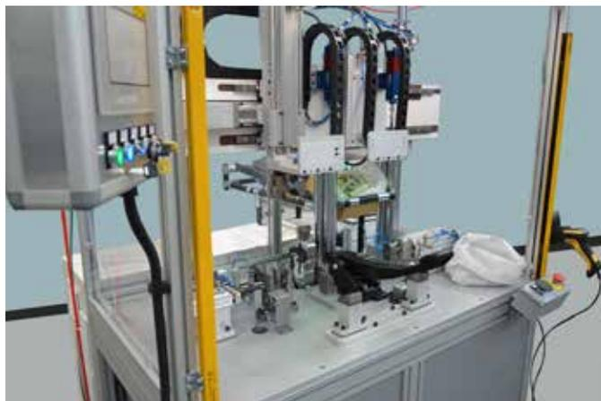
Assemblaggio perno freno
