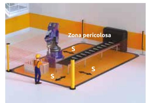
Fig. 35. Protezione su tre lati con l'utilizzo di specchi
