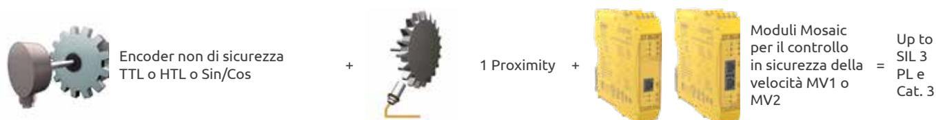
I due sensori non di sicurezza (encoder e proximity) formano un sistema doppio canale. I moduli Mosaic (MV1 o MV2) controllano:
