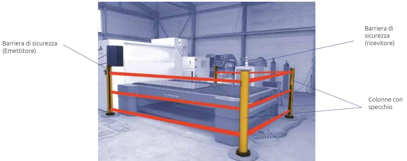
Fig. 48. Protezione perimetrale di una macchina per taglio laser
